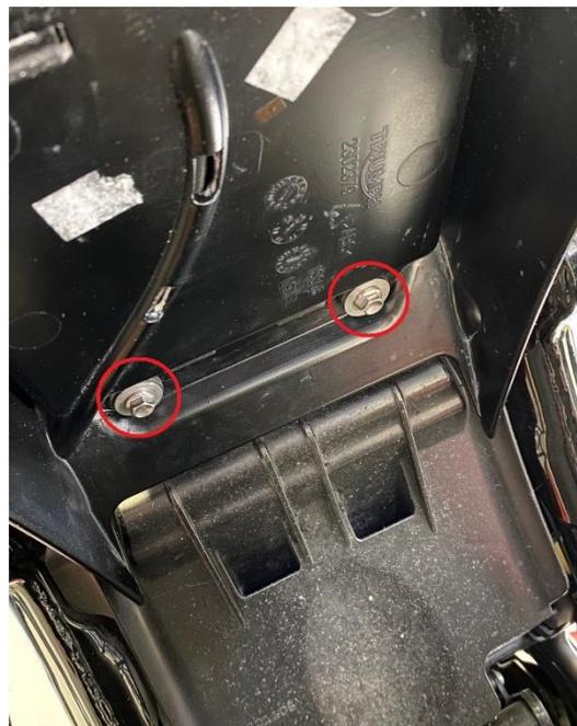
4. Halteblech vom Steuergerät ausclippen, Steuergerät herausnehmen und zur Seite hängen. Achtung, bei Thruxton RS Modellen ist die ECU mit 2 Torx Schrauben verschraubt, diese herauschrauben
