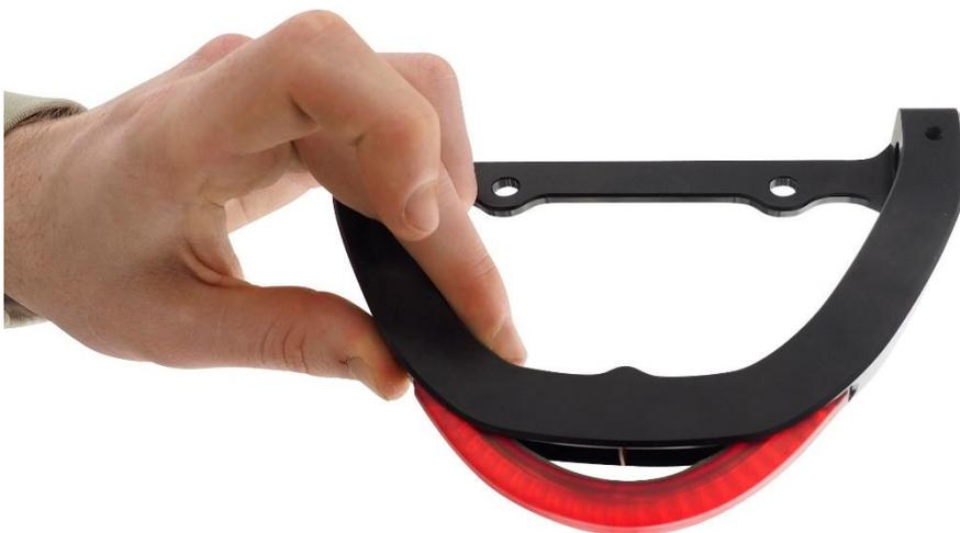
6. Drücken Sie auf die Mitte des LED-Streifens. Der LED-Streifen sollte nun leichtgängig und gleichmäßig in das Gehäuse gleiten. Drücken Sie anschließend den LED-Streifen flächig an und halten Sie diesen ca. 1 Minute.
