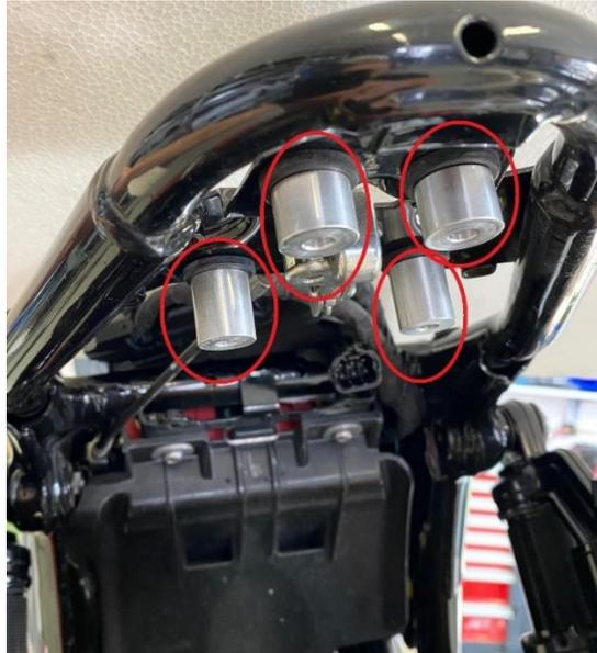
2. **Thruyton 1200 / R / TFC:** Mit den 2 original Schrauben + U-Scheiben die Heck-Innenverkleidung ansetzen, zusätzlich kommen die beiden kurzen Buchsen mit dem Alublech (die 2 Schlitz in dem Blech müssen nach hinten zeigen) ins Innere der Heck Innenverkleidung. Schrauben noch nicht festziehen
