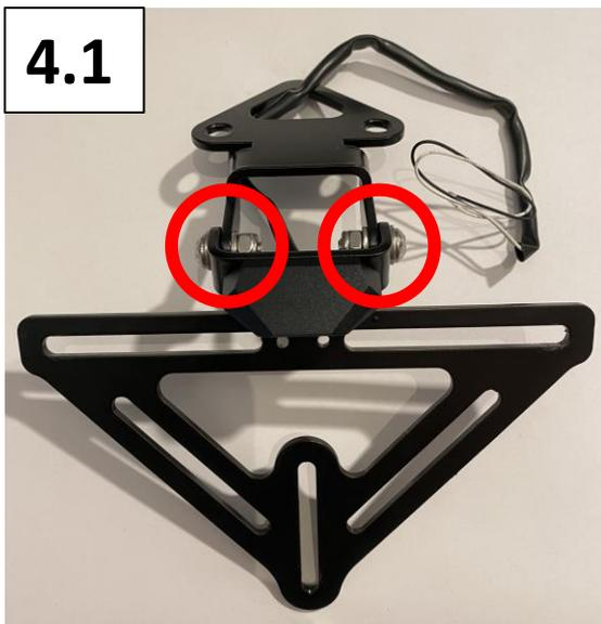
Kennzeichenleuchte an die Kennzeichenhalterung verschrauben.
