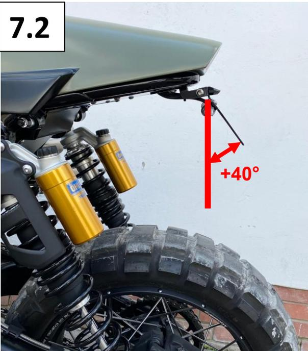
Kennzeichenwinkel einstellen und die **Verschraubung GUT festziehen!**
