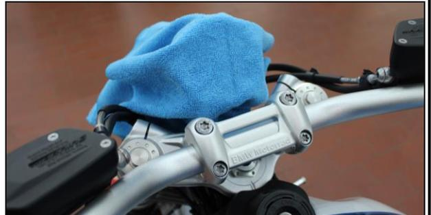
Die vier Befestigungsschrauben des Lenkers gegen den Uhrzeigersinn lösen und entnehmen.
